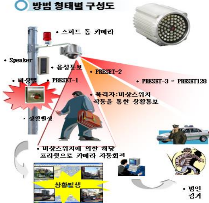
생활 방법용 CCTV
