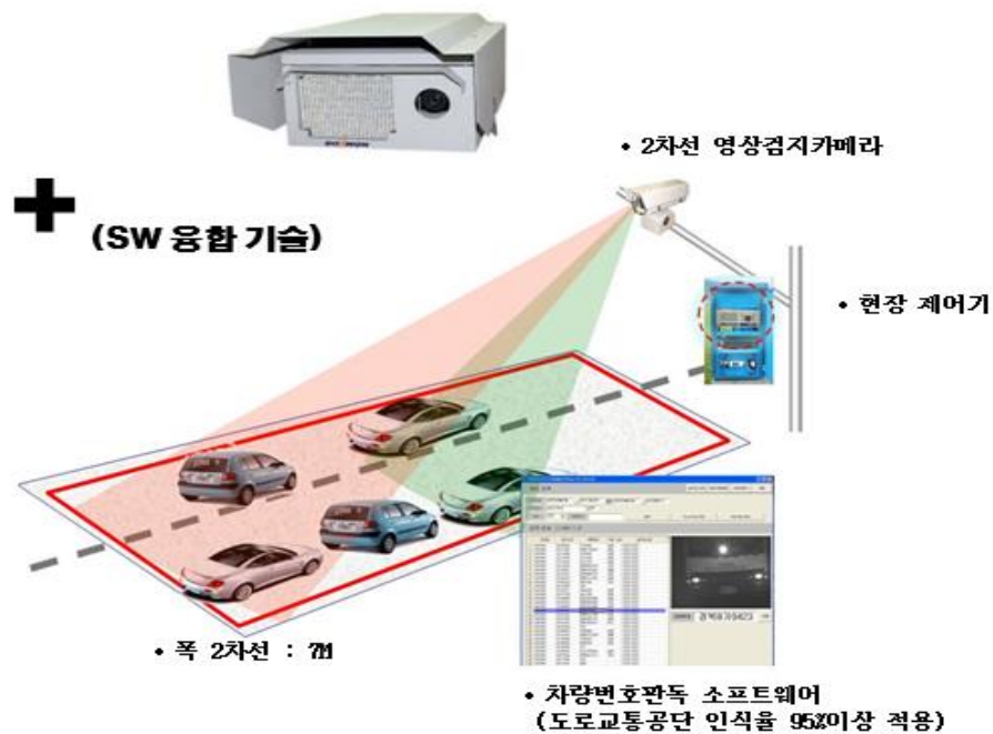
도로 방법용 차량번호 판독 CCTV
